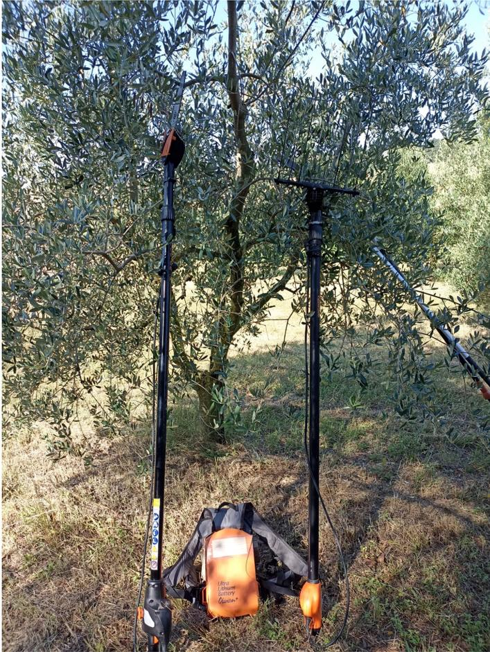
Nell' utilizzo delle attrezzature azionate da batteria portata con zaino a spalla si possono ridurre i rischi maggiori legati al rumore dei motori a scoppio. Questo può essere quasi del tutto azzerato con l'azionamento a batteria. A
